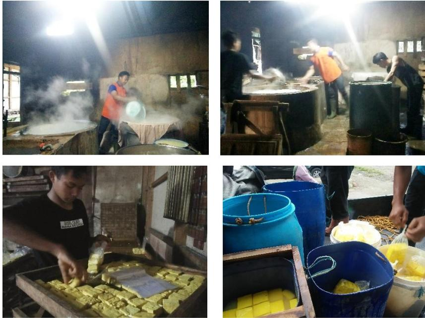
Gambar 9. Proses Pemerasan, Pencetakan, Pewarnaan dan Pengemasan
