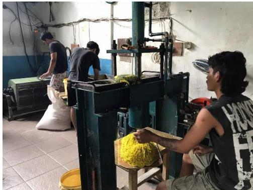
Gambar Lampiran 2. 3. Proses Pencetakan Menggunakan Mesin Press Hidrolik
