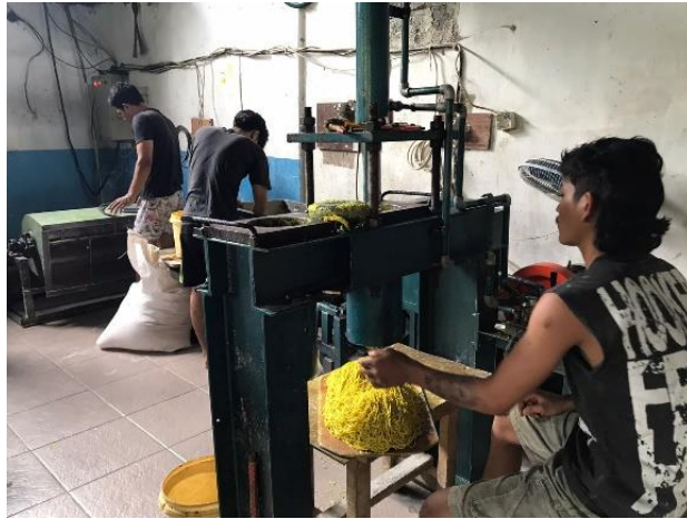
Gambar 3. Proses Pencetakan Menggunakan Mesin Press Hidrolis
