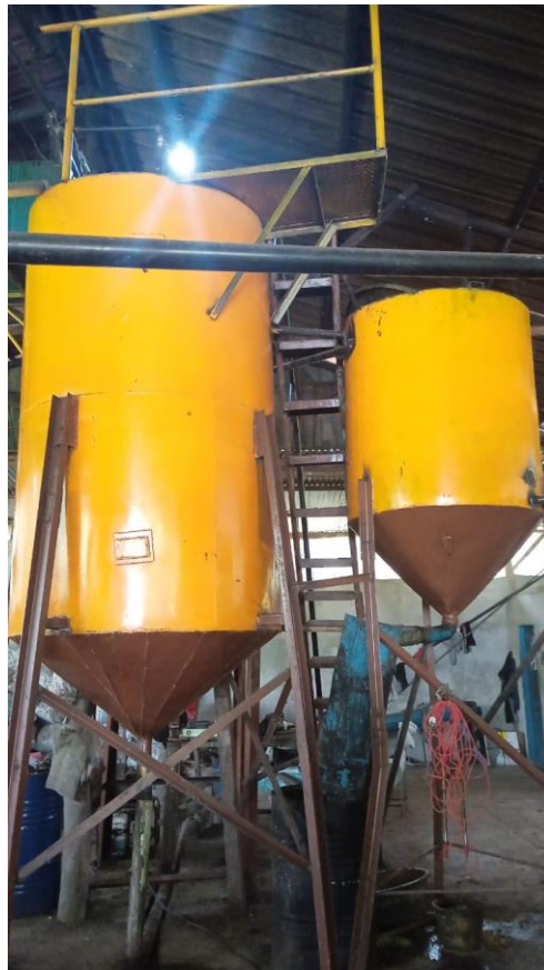
Tangki penyaringan minyak setelah brondolan difress
