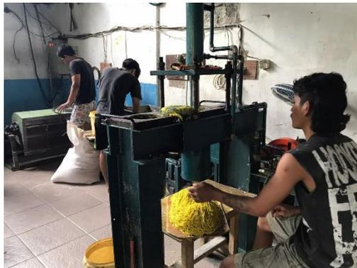
Gambar 5. Proses Pencetakan Menggunakan Mesin *Press* Hidrolik
