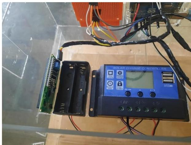
Gambar 24. Combine dengan Solar Charger Controller dan tempat baterai
