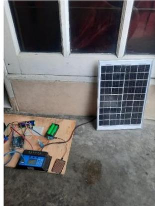
Gambar 19. Solar Panel dan Solar Charger Controller
