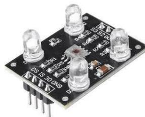
Gambar 2. Sensor Warna TCS230
