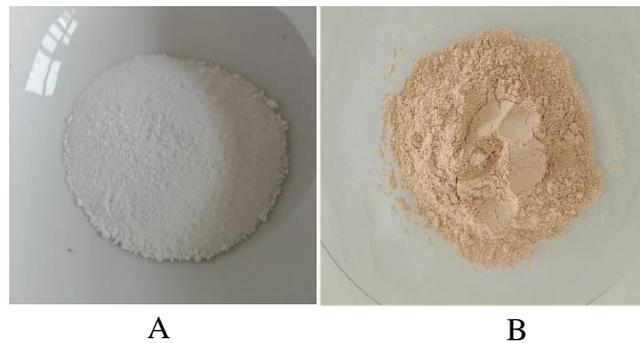
Gambar 4. A.  $\text{TiO}_2$  Hasil Sintesis dari  $\text{TTiP}$ ; B. Nanokomposit  $\text{TiO}_2$ /zeolit
