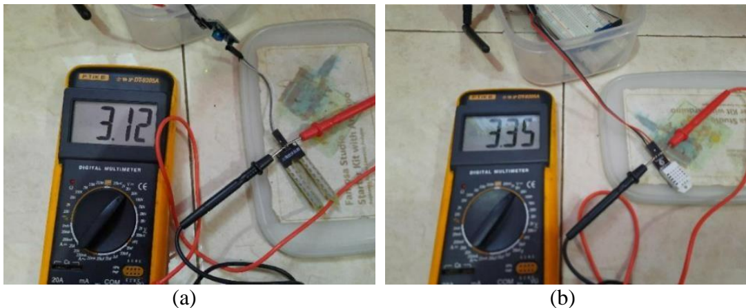
Gambar 18. Proses Pengujian Sensor Soil Moisture (a) dan Sensor DHT22 (b)
