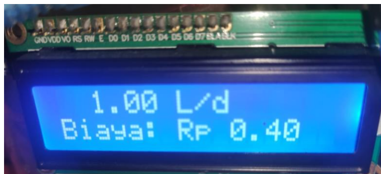
Gambar 24. Validasi Sensor Flowmeter dengan Gelas Ukur 1.000 ml
