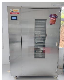
Dimasukan dalam dehumidifeir 7 jam dengan suhu 50°C dan Rh 17%
