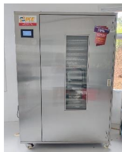
Dimasukan dalam dehumidifier 7 jam dengan suhu 50°C dan Rh 17%
