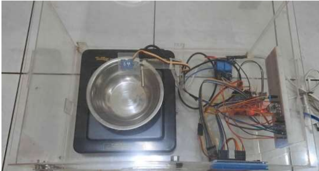
Gambar 20. Sisi Dalam Alat Pendeteksi Kadar Formalin
