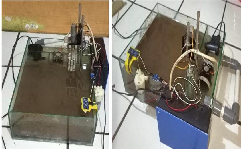
**Gambar 16. Tampilan Alat Model Sistem Air Irigasi Sawah Tampak Depan dan Belakang**
