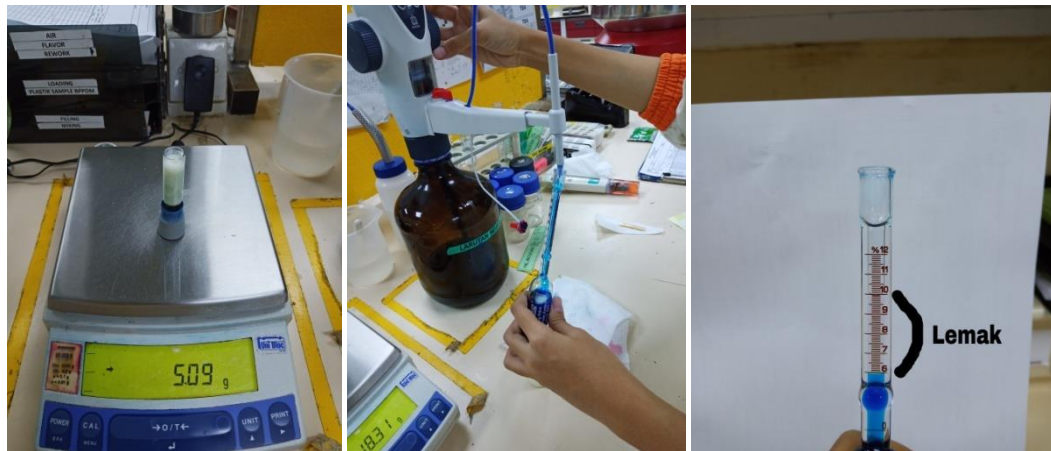
Gambar 5. Proses Uji Kadar Lemak Metode Gerber
