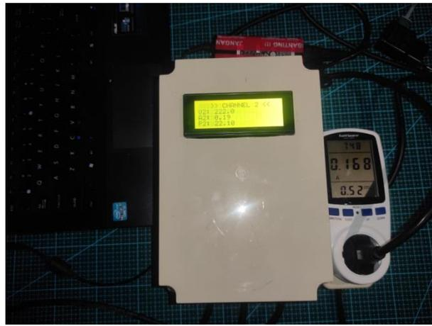
**Gambar 31.** Pengujian Validasi Arus (I) Sensor PZEM-004T Channel 2
