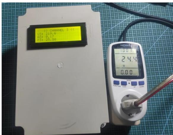
**Gambar 32.** Pengujian Validasi Daya (P) Sensor PZEM-004T Channel 3
