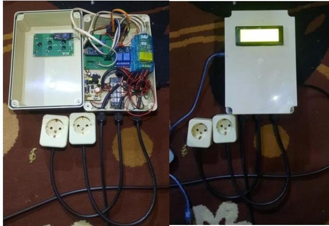
**Gambar 27.** Tampilan tampak dalam dan luar *prototype charging station*
