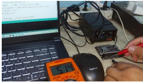
Gambar 12. Pengujian NodeMCU ESP8266
