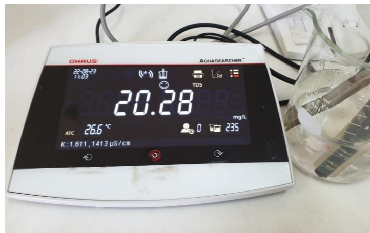
Gambar 13. Pengukuran TDS Air Hujan
