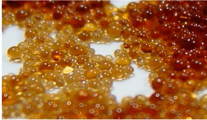
Gambar 1. Penampilan fisik resin pertukaran ion (diameter granul 1-2 mm)
