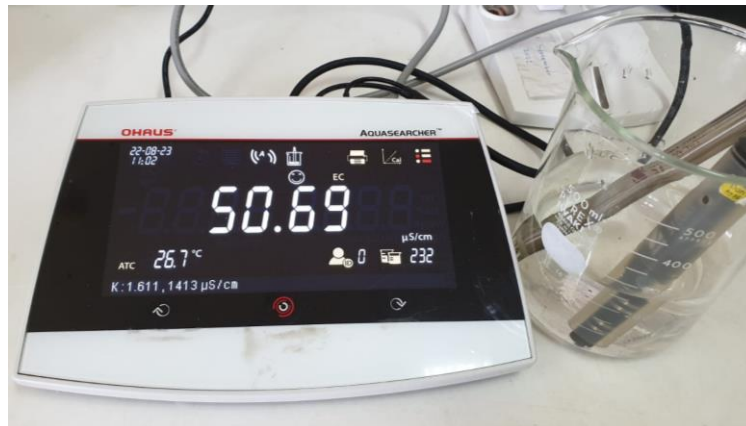
Gambar 11. Pengukuran DHL Air Hujan
