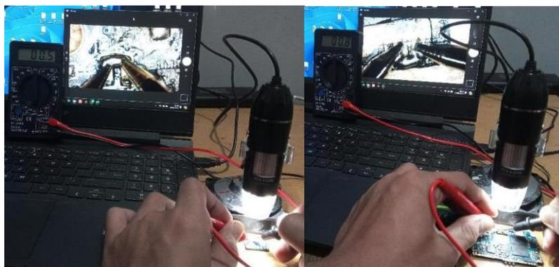
Gambar 27. Inspeksi Kelistrikan Solder Defect
