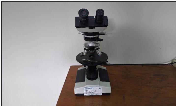
**Gambar 1.5:** Mikroskop polarisasi untuk analisis sayatan tipis batuan.
