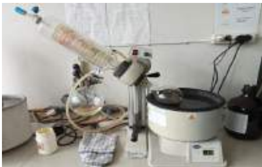
Gambar 8. Tahap penguapan sampel dengan rotary evaporator menggunakan etanol 70%
